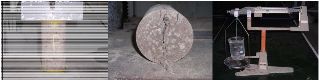
Gambar 6. Pengujian kuat tekan, belah dan porositas di laboratorium
