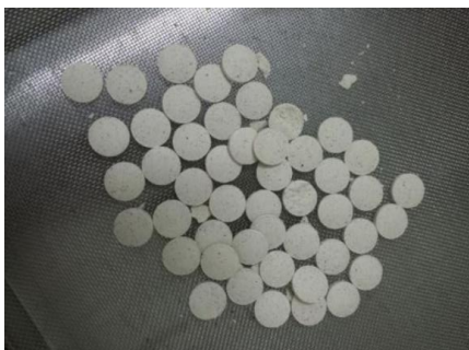
Gambar 1. Slugging dari Campuran Ekstrak, Asam dan Basa (1) dan Penghancuran Slugging untuk Pembuatan Granul sebelum Diayak (2)
