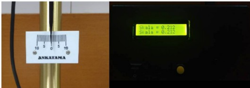
Gambar 8. Hasil pengamatan posisi jarum secara visual (kiri) dan pembacaan sensor (kanan)
