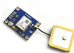
Gambar 4 sensor GPS Neo-6M
