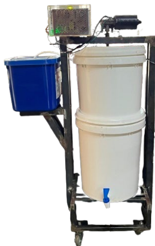
Gambar 1. Desain sistem pengomposan otomatis.
