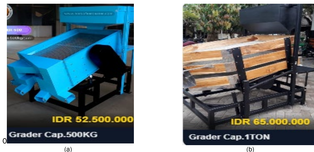
Gambar 1. Desain produk sistem sortir kopi dipasaran (a) sistem sortir berdasarkan ukuran terbuat plat baja (b) Sistem sortir terbuat dari bahan kayu (Sumber : [12])
