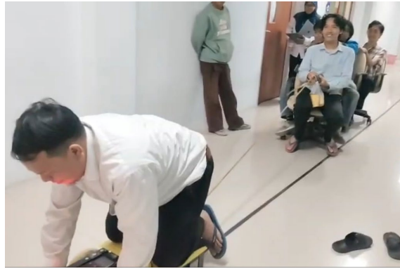
Gambar 13. Pengujian AGV pada lintasan magnet dengan menarik beban > 400 kg
