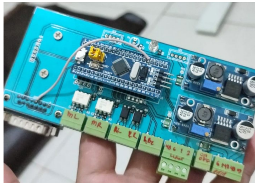
Gambar 12. Implementasi desain PCB yang telah dicetak.
