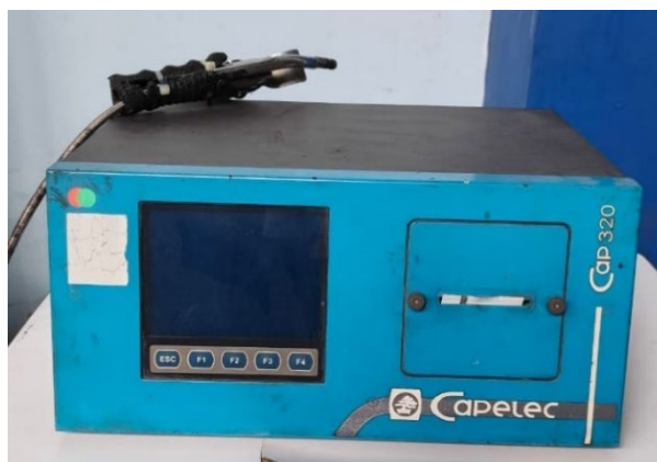
Gambar 6. Perangkat gas analyzer berspesifikasi Kelas 0 untuk pengujian kalibrasi sensor MQ-7
