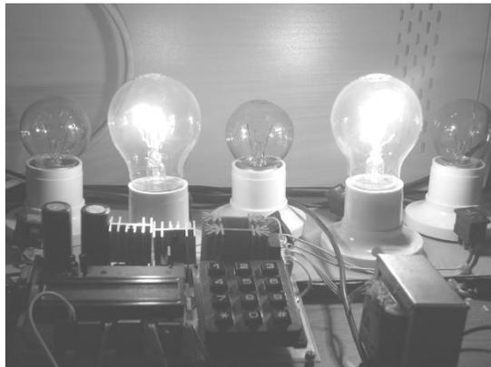
**Gambar 9** Penyalan sistem lima lampu untuk *set point* sama dengan dari 110 watt
