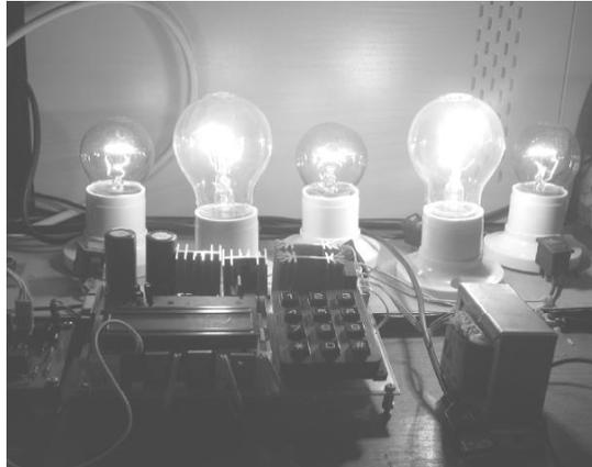
**Gambar 8** Penyalan sistem lima lampu untuk set point sama dengan atau lebih dari 160 watt
