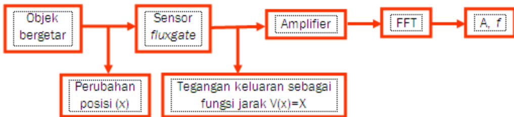
Gambar 2 Prinsip Kerja Fluxgate Sebagai Sensor Getaran [9]
