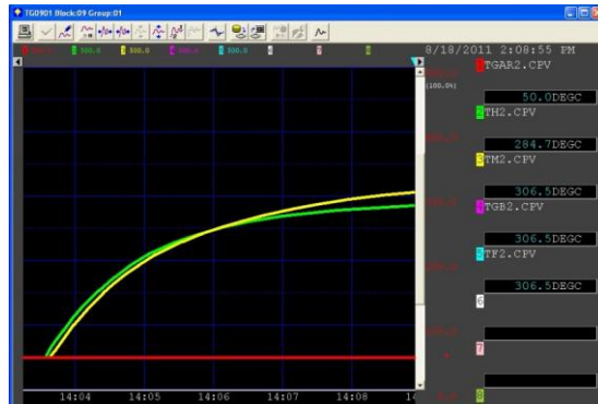
Gambar 2 Grafik kenaikan temperatur reaktor saat startup
