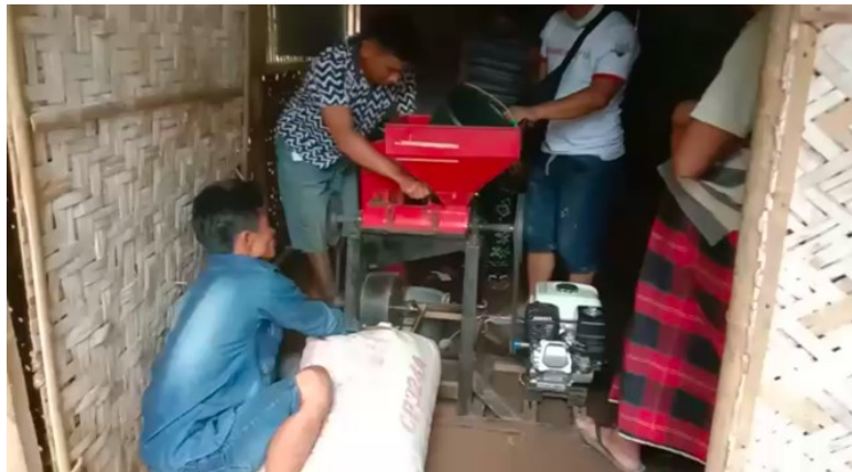
Gambar 3. Proses pengupasan kulit ari biji kopi dengan huller
