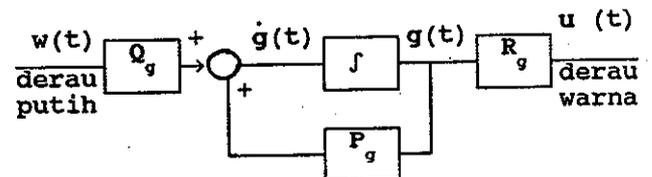
Gambar 3. Filter bentuk gelombang jalan
