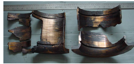
Gambar 4. Tipikal kerusakan yang terjadi pada bantalan luncur produk impor [6]
