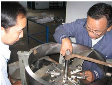
(b) Setting sudu satu per satu, kemudian dilakukan pengecekan
