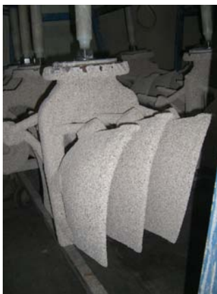
(f) Wax pattern assembly yang telah dilapisi campuran bubuk keramik
