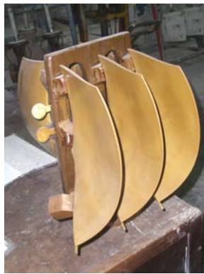
(e) Wax pattern assembly untuk sudu runner
