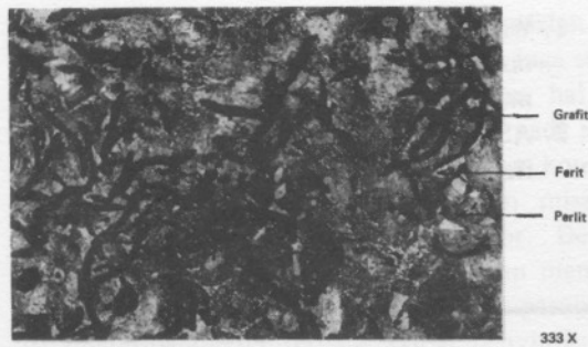
Gambar 2. Struktur mikro logam induk. Etsa : Nital 2,5 %
