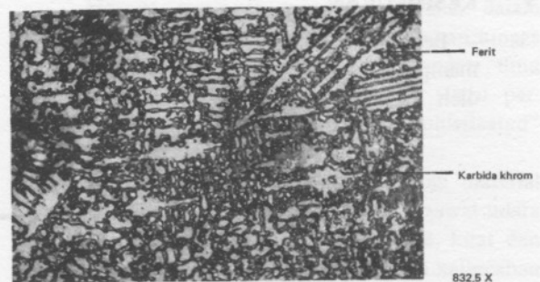
Gambar 5. Struktur mikro logam las pada posisi A dan B. Etsa: 20 ml HCl, 10 ml HNO 3 , 30 ml H 2 O.
