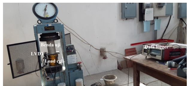
Gambar 3. Setting pengujian kuat tekan dan modulus elastisitas silinder mortar.
