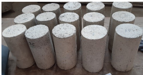
Gambar 2. Benda uji silinder mortar (15 buah)
