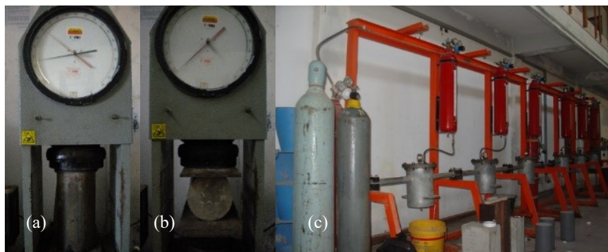
Gambar 3. Pelaksanaan uji kuat tekan (a), kuat tarik belah (b), dan permeabilitas (c)
