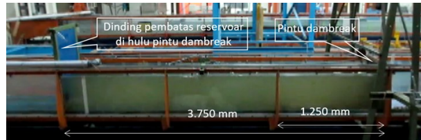
Gambar 1. Peletakan dinding pembatas reservoir di hulu pintu dambreak
