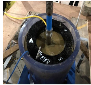
Gambar 10. Dokumentasi pasca pemberian beban dinamik pada material sampel tanah
