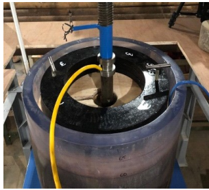
Gambar 9. Dokumentasi pasca pemberian beban surcharge pada material sampel tanah
