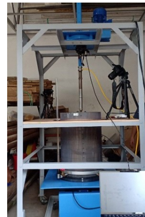
Gambar 8. Dokumentasi persiapan pengujian piezocone
