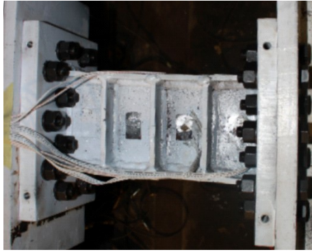
Gambar 31. Deformasi akhir link-2
