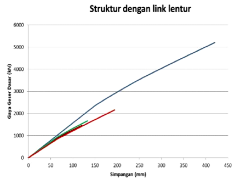
Gambar 8. Kurva push-over struktur dengan link lentur
