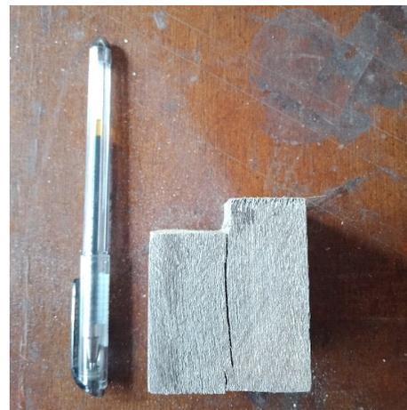
**Gambar 8. Kerusakan pada uji kekuatan geser pada batas proporsi kayu**
