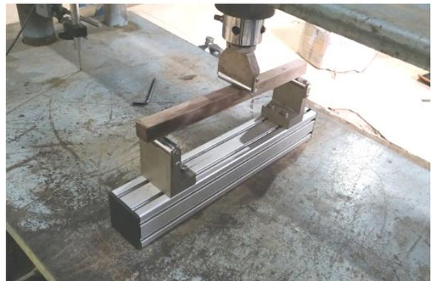
Gambar 4. Pengujian lentur statis
