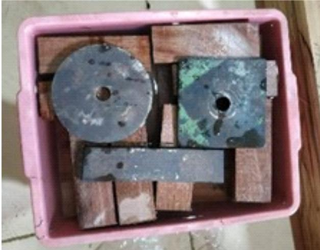
Gambar 1. Perendaman sampel untuk mendapatkan kadar air yang diinginkan
