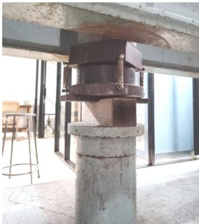
Gambar 2. Pengujian tekan tegak lurus serat
