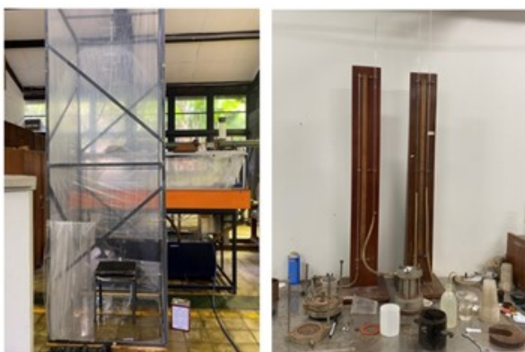
Gambar 3. Alat uji rainfall simulator dan falling head
