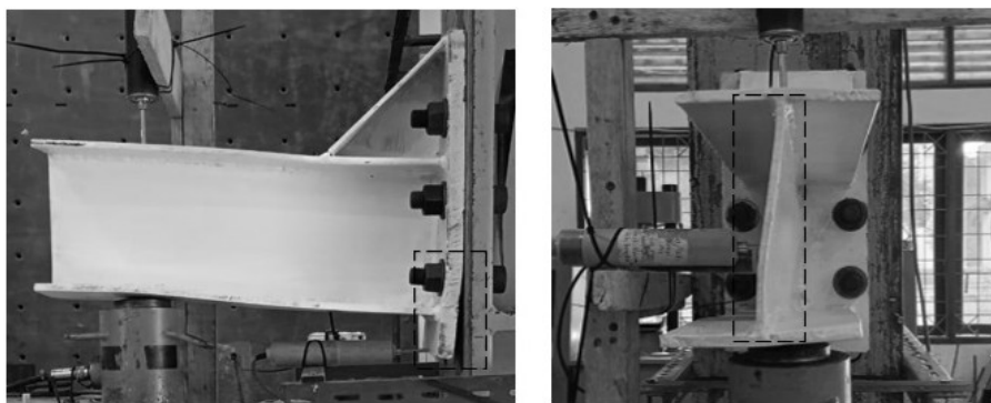
Gambar 16. Ragam kegagalan S2: (a) Gagal lentur pada pelat ujung; (b) Tekuk pada pelat badan di posisi beban geser
