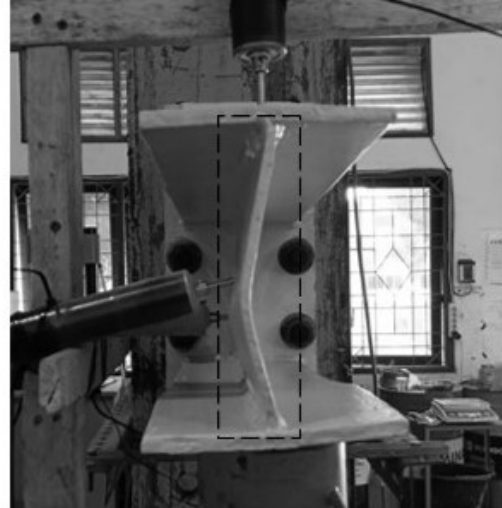
Gambar 18. Ragam kegagalan S4: (a) Gagal lentur pada pelat ujung; (b) Tekuk pada pelat badan di posisi beban geser
