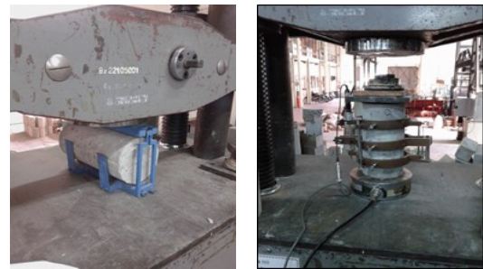
Gambar 7. Uji tarik belah dan modulus elastisitas
