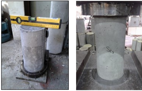
Gambar 5. Capping benda uji dan uji tekan.
