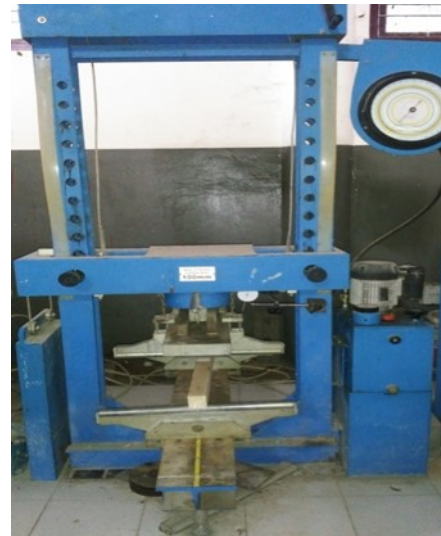
Gambar 4. UTM untuk uji TPB pada 4 tipe benda uji
