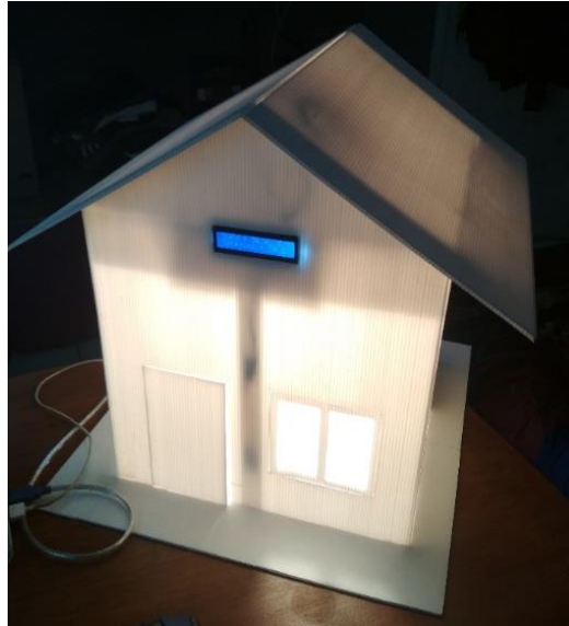
Gambar 53. Kendali suhu pada prototipe simulator penetas telur ayam menggunakan lampu pijar
